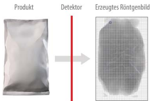
Abbildung 6: Erzeugung von Röntgenbildern
