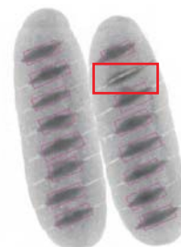
Abbildung 4: Zwei Knoblauchbaguettes – eines ist unterfüllt.
