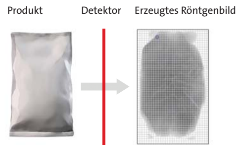
Abbildung 1: Erstellung eines Röntgenbildes.
