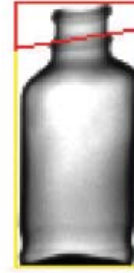
Abbildung 7: Erkennen eines fehlenden Verschlusses.
