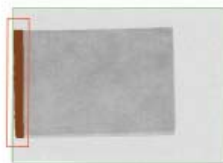
Abbildung 18: In der Versiegelung eingeklemmter Wundverband.
